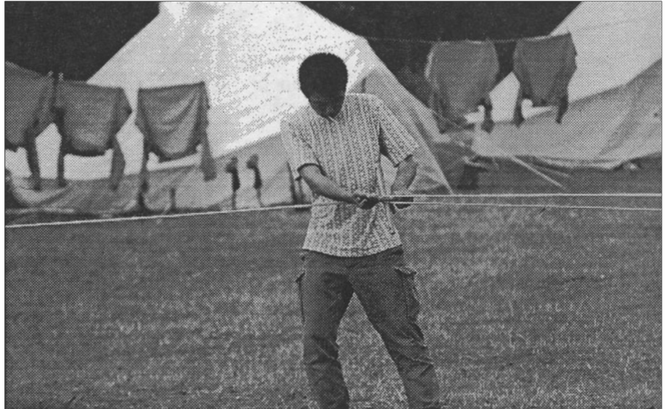
Mit einem Holzkreuz wird verhindert, daß die einzelnen Fasern verheddern.
